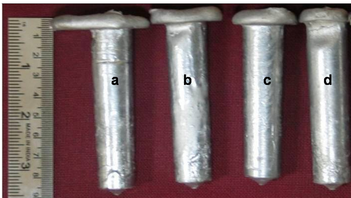
Fig. 1. Photograph of matrix alloy (a) and zircon reinforced composites b) 3 v % (c) 6 v % and (d) 9 v %
